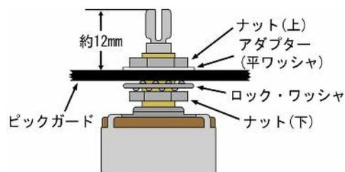
ポットをピックガードに取り付ける場合は、上の図のようにナットとワッシャを使用して下さい。
